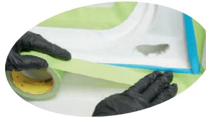
Cintas especializadas en la protección del vehículo durante el proceso de detallado.
